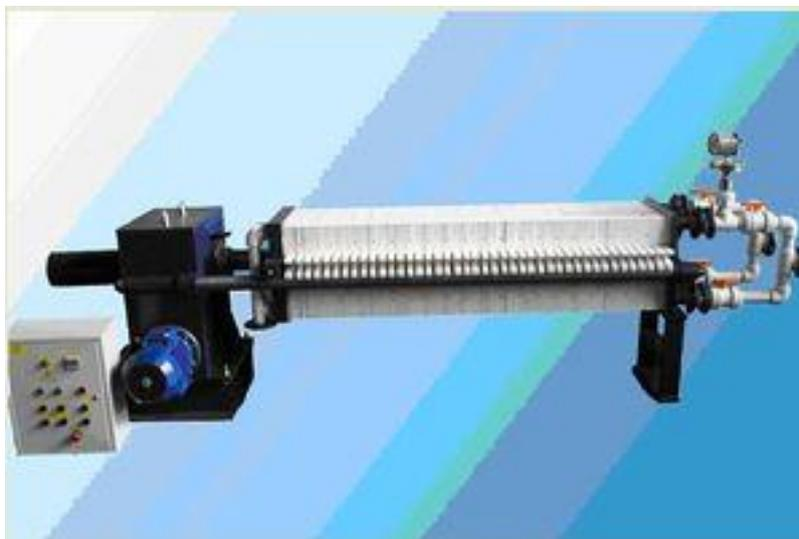
Рис.2. Фильтр-пресс с электромеханическим зажимом
