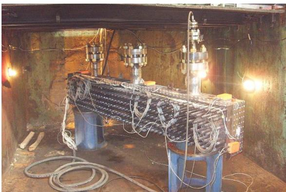
**Испытания на прочность коллектора аппарата воздушного охлаждения, рабочее давление 25 МПа**
