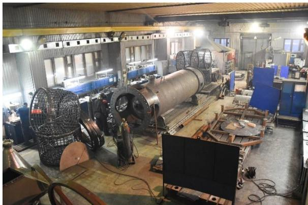
**Механосборочный участок. На стапеле скруббер-охладитель. В цехе - готовые корзины углеобжига**
