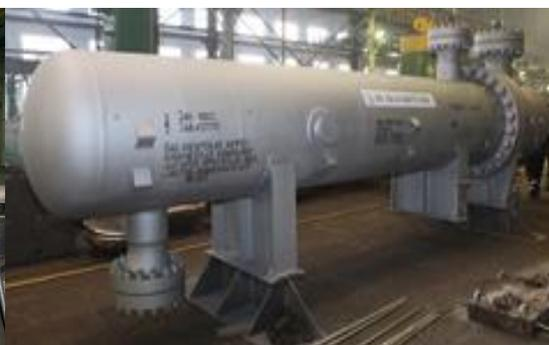
**Теплообменные аппараты высокого давления в установке гидроочистки яжелого газойля коксования комплекса НП и НХЗ для ПАО «Татнефть»**
