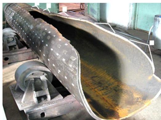
**Исследования прочности сепаратора-маслоотделителя (Германия). Разрушение произошло при давлении 112 МПа**
