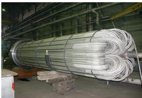
**Подогреватель воды установки производства метанола (трубные пучки с U-образными трубами «фонтанного» типа)**
