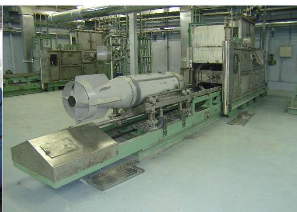
**Линия подготовки расснаряжения химических авиабомб**
