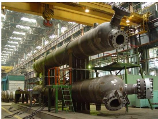
**Подогреватель воды двухкорпусной,  $P=30$  МПа,  $T=350^{\circ}\text{C}$  для агрегатов синтеза аммиака для АО «Невиномысский Азот», ЧАО «Северодонецкое объединение Азот», ПАО «ТольятиАзот» и др.**
