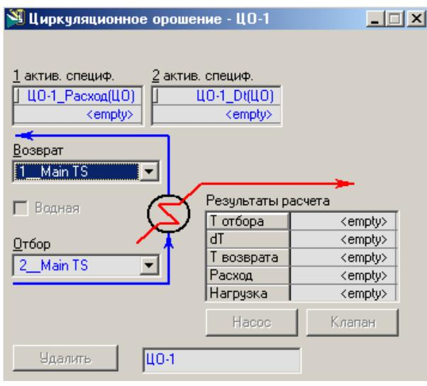
Спецификациями являются: расход орошения  $350 \text{ м}^3/\text{час}$  и нагрузка  $-3.5 \cdot 10^6 \text{ ккал}/\text{час}$ . Аналогичным образом задайте еще два орошения со следующими параметрами:
