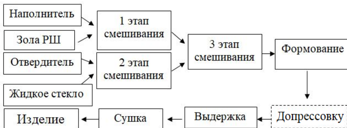
Рисунок 4 – Технологическая схема изготовления образцов композиционного материала, пунктиром показаны необязательные стадии
