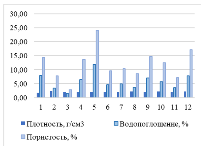
Рис. 2 Значения плотности, водопоглощения и пористости модифицированного полуфарфора
