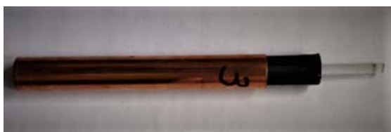
Рис. 1 Оптический капсюль - детонатор (ОКД) в сборе.
