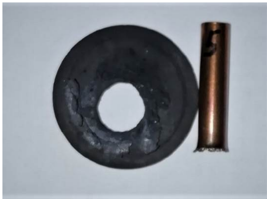
Рис. 5 Пробитие свинцовой пластины - свидетеля.
