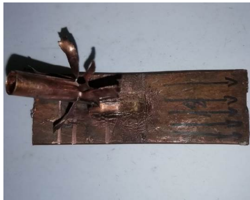
Рис. 6 Определение длины перехода горения в детонацию на медной пластине – свидетеле.
