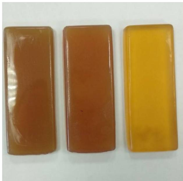
Рис. 2. Образцы материалов на основе полиэфирной смолы с наночастицами ZnO, и водой в концентрации 20, 10 и 0 масс.% (слева направо)
