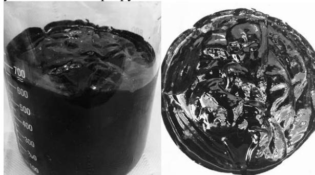
Рисунок 1. Образец гель-содержащей водонефтяной эмульсии
