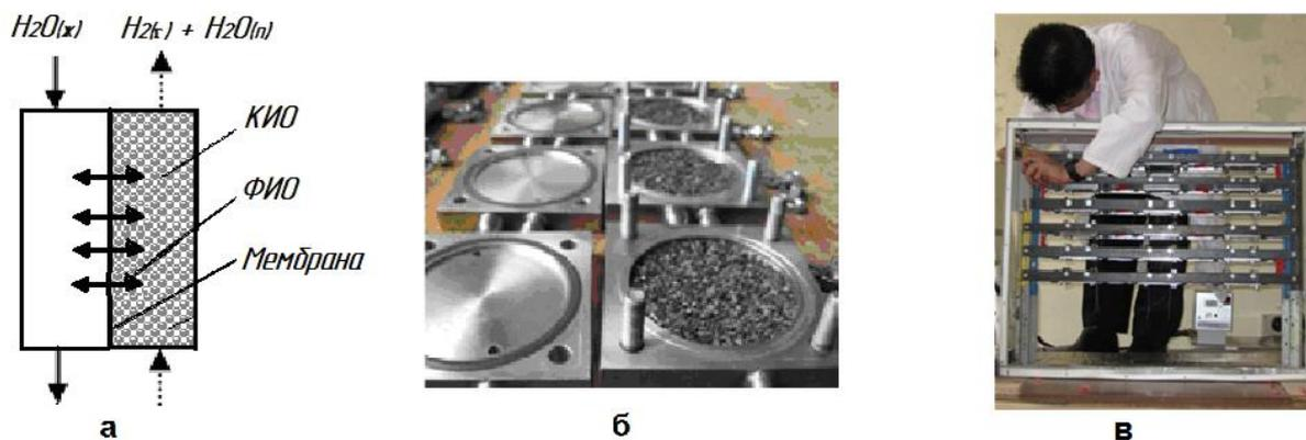
Рис. 1. Контактные устройства мембранного типа: а – принципиальная схема; б – элементы КУМТ; в – сборка противоточной колонны с КУМТ
