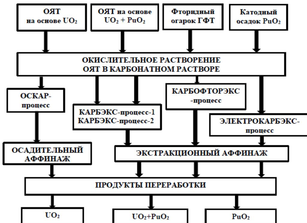
Рис. 1. Семейство процессов переработки ОЯТ на основе КАРБЭКС-процесса
