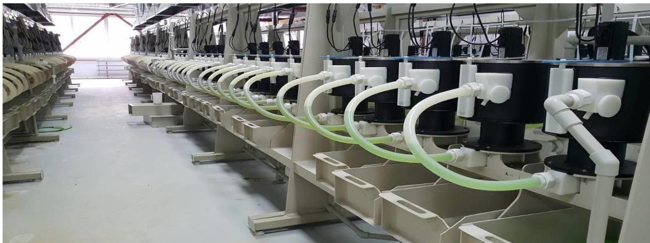
Рисунок 2 – Фрагмент каскада разделения по линии Nd/Pr, число ступеней – 93
