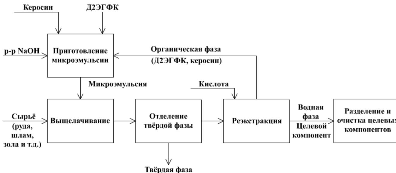
Рис. 1. Принципиальная схема микроэмульсионного выщелачивания
