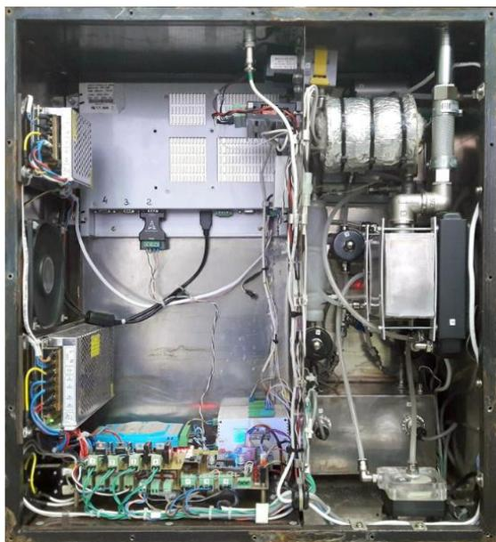
Рис. 1. Вид устройства пробоотборника на основе ФИО
