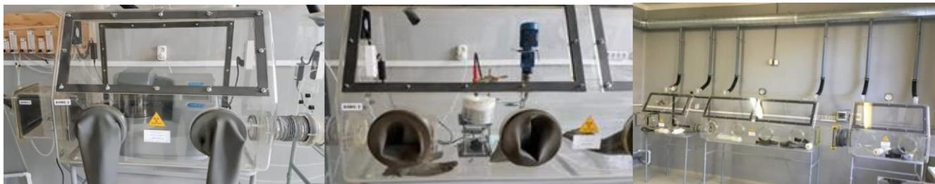
Рис. 2. Технологическая линия по сборке бетавольтаических источников
