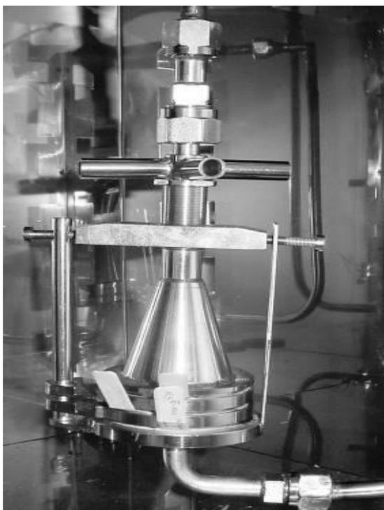
Рис. 1. Секционированный держатель контрольного иодного стенда
