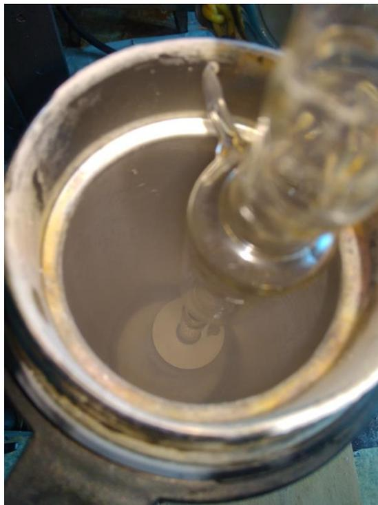
Рис. 1. Реактор в магнитном поле при 77 К
