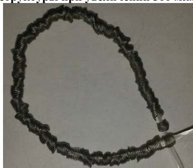
Рис.3. Спиралевидный металлический носитель, нанизанный на стекловолоконную нить.
