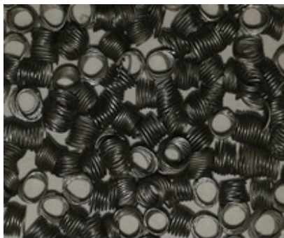
Рис.1. Внешний вид ячеисто-каркасного спиралевидного металлического носителя.
