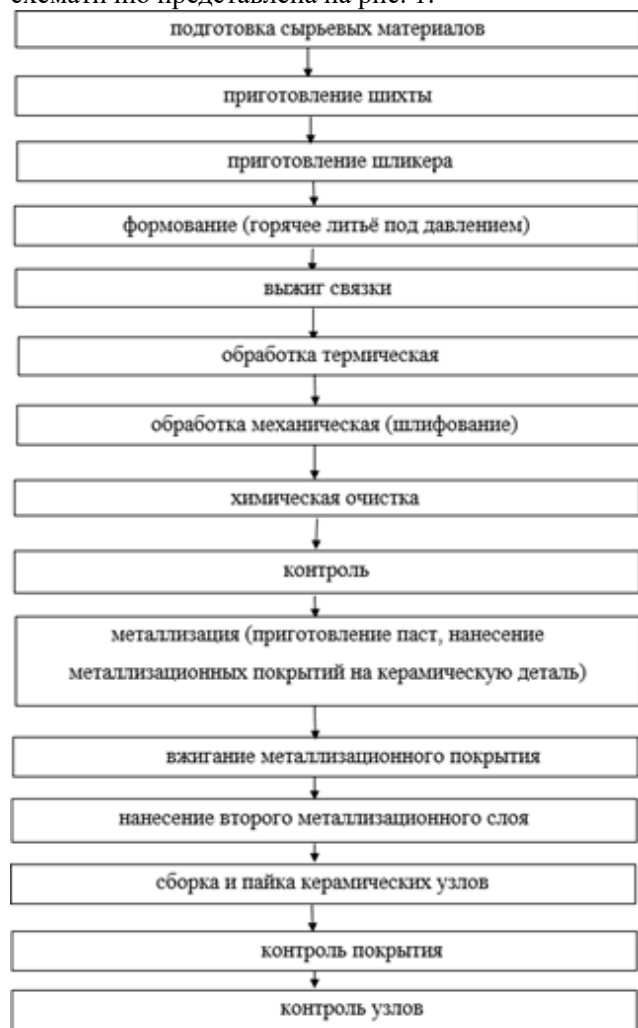
Рис. 1. Схема изготовления керамики.
