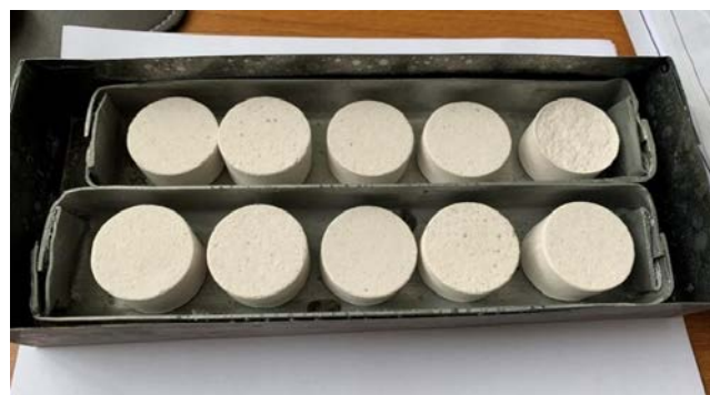
Рис.2.Брикетты шихты стекла в молибденовых лодочках
