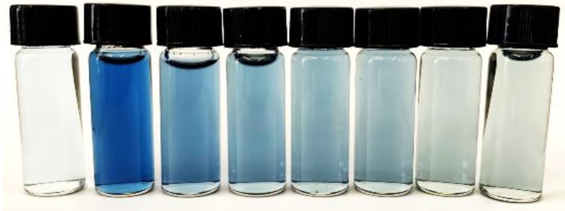
Рис.1. Внешний вид полученных образцов с различным мольным соотношением [R]/[Mo] (разбавление – 400 раз) слева направо: 0,01; 0,1; 0,3; 0,5; 0,7; 1; 3; 5
