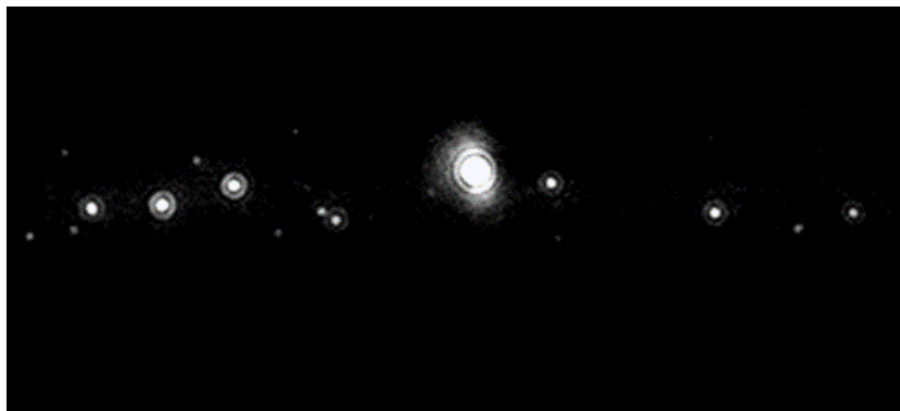
Рис. 1 - Характерный вид поля зрения ультрамикроскопа. Наночастиц SiO 2 ( R=55 нм) в воде. Каждая светящаяся точка на рисунке – рассеяние от отдельной наночастицы.
