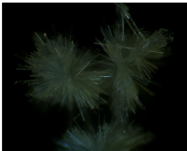
Рисунок 2. Микрофотография осажжденного сульфата кальция Благодаря повышенной энергии активации, при
