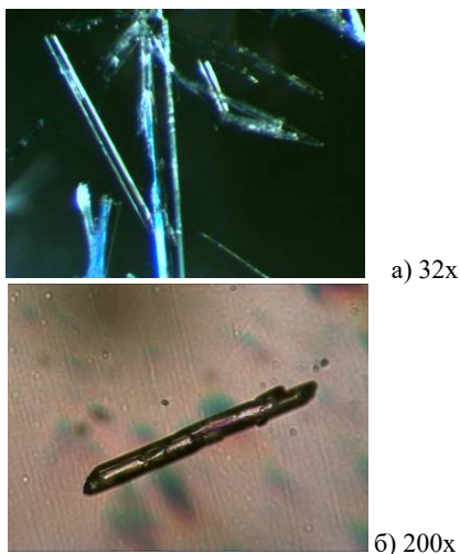
Рис. 4. Внешний вид кристаллов гипса, выращенных в растворе Melment F15 G
