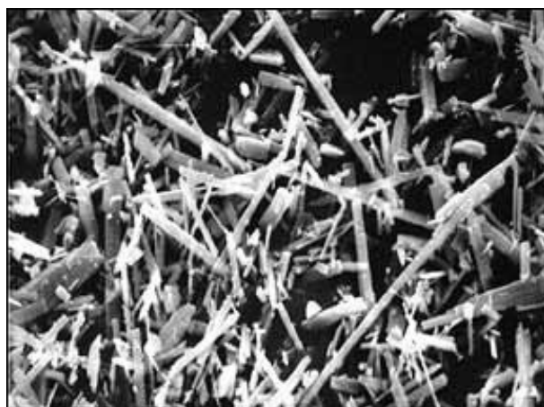
Рис. 1 Микроглы волластонита X1700
