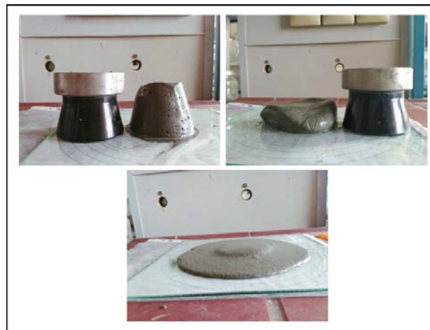
Рис.2. Распływ конуса цементного теста с добавками: сверху слева - с Melflux 1641 F; сверху справа - с Melflux 1641 F и Vinnapas 5010 N; внизу - Melflux 1641 F и песок
