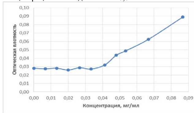
Рисунок 1. Зависимость оптической плотности растворов амилазы, определяемой методом Лоури, от ее концентрации в растворе
