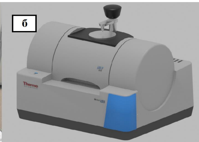
Рис.3. Виртуальная модель ИК-спектрометра «Nicolet iS5» (а – фото, б - 3D-модель)
