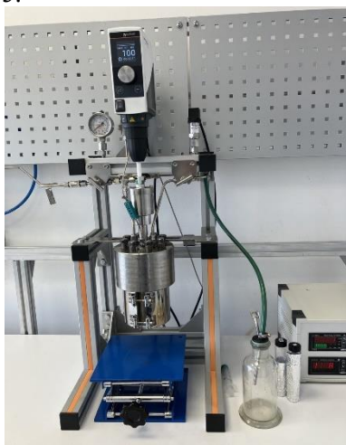
Рисунок 13. Установка для проведения гидролиза в субкритической воде
