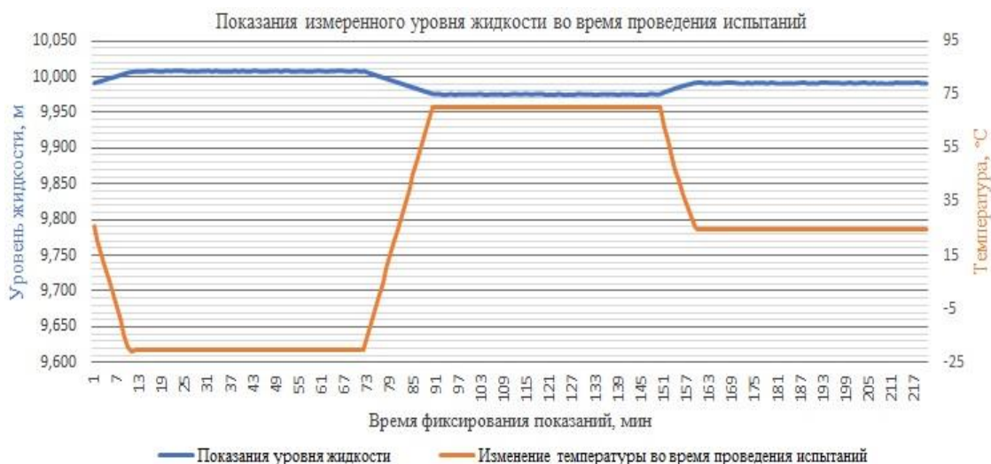
Рис.1. График влияния температуры на изменение уровня столба жидкости
