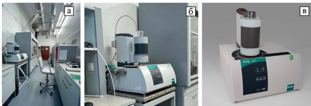
Рис. 2. Виртуальная модель термического анализатора «STA 449 F5 Jupiter»
