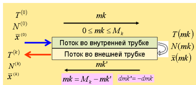
Рис.2. Схематическое изображение политропического реактора с внутренним теплообменом
