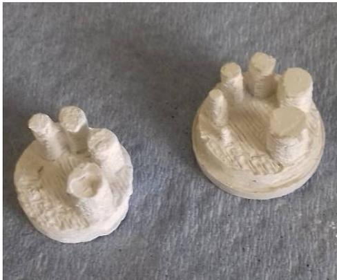
Рис. 2. Образцы керамики на основе ТКФ (слева) и ОКФ (справа)
