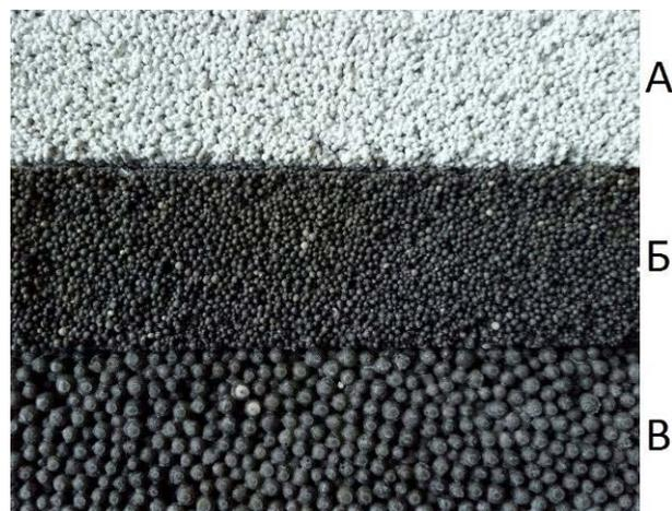
Рисунок 4. Внешний вид теплоизоляционных материалов на основе гранул пеностекла (А-воластонит, Б-микрокремнезем, В-маршалит).
