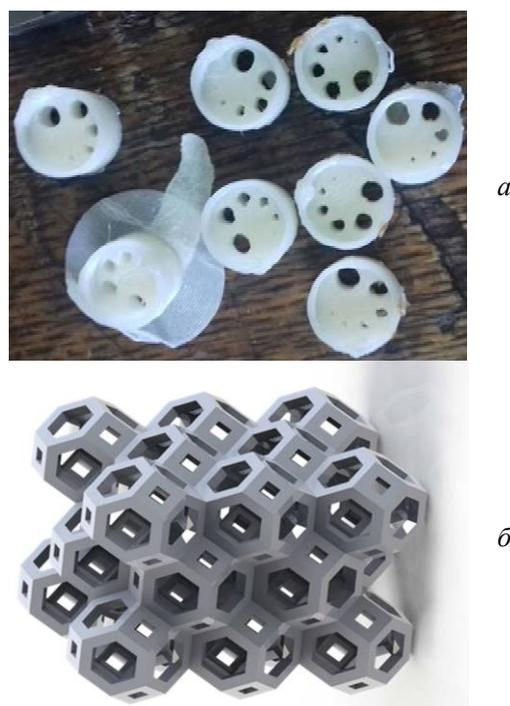
Рис. 1. Модельные формы для горячего литья: а – тигли; б – структура Кельвина (по [6])
