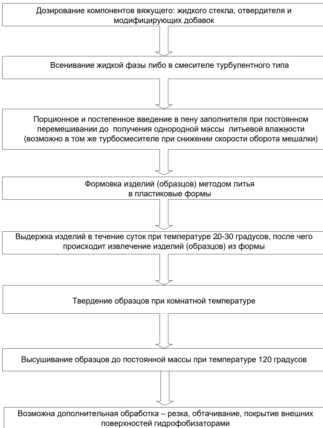
Рис. 2.3 Принципиальная схема приготовления образцов теплоизоляционного материала
