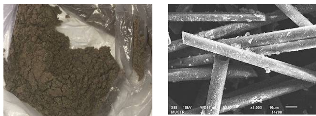
Рис. 1. Продукт термической переработки деталей оргтехники из стеклопластика; слева – внешний вид, справа – СЭМ с увеличением \times 500
