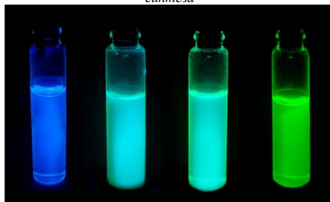
Рис. 3. Видимая фотолюминесценция при освещении УФ (365 нм) для образцов \text{CH}_3\text{NH}_3\text{PbBr}_3 , полученных при температуре от 5°C до 60°C (слева направо)
