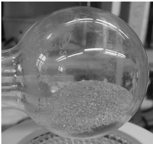
Рис.5. Покрытие хлорида натрия металлическим натрием в среде чистого аргона
