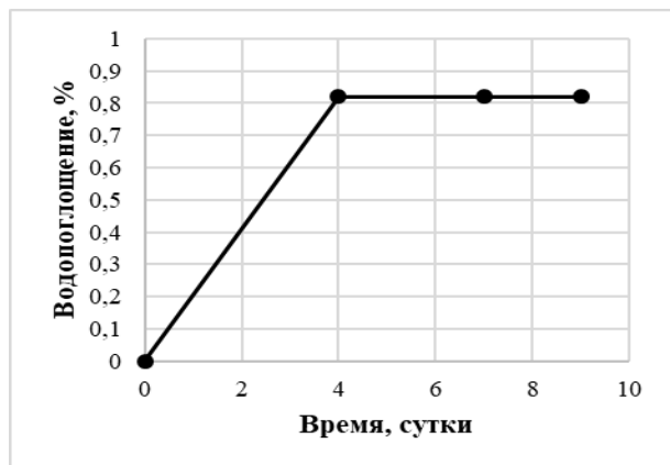
Рис. 3. Изменение водопоглощения во времени полимерной пленки
