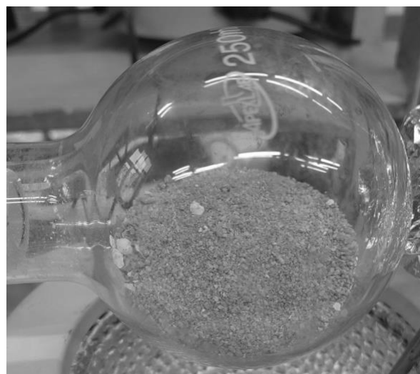
Рис. 4. Покрытие хлорида натрия металлическим натрием в среде аргона с содержанием кислорода воздуха не более 10 %
