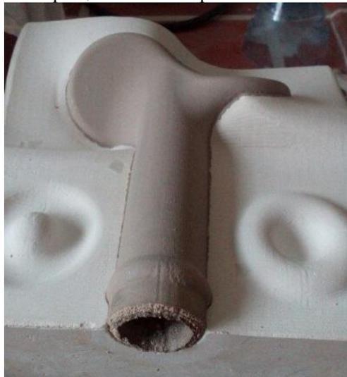
Рис.2. Образец полый мешалки, полученный способом сливного шликерного литья.
