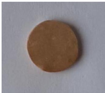
Рис. 2. Образец керамики ИАГ, синтезированный методом прессования при сверхвысоком давлении.
