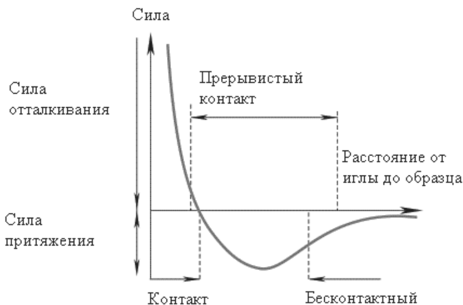
Рис. 21. Зависимость силы взаимодействия от расстояния между кончиком иглы и поверхностью образца [5]
