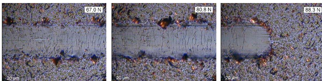
Рис. 2. Характер разрушения покрытия Ti(Al) – Mo – Ni – N
