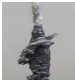
Рис.1. Катодно-солевая груша, полученная электролизом расплава KCl - NaCl с добавкой K_2SiF_6 - KBF_4 (1 мол.% - 3 моль.%) при температуре T = 750^\circ C , E = -2,6
