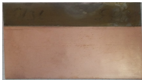
Рис. 1. Внешний вид медного покрытия, осаждённого в угловой ячейке Хулла при I = 0,5 A , t = 50^{\circ}C , pH = 9,5 , C(Cu^{2+}) = 7,5 г/л , C(ЛФО2) = 150 г/л
