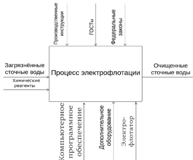
Рис.1. Контекстная IDEF0-диаграмма процесса электрофлотации на производстве.
