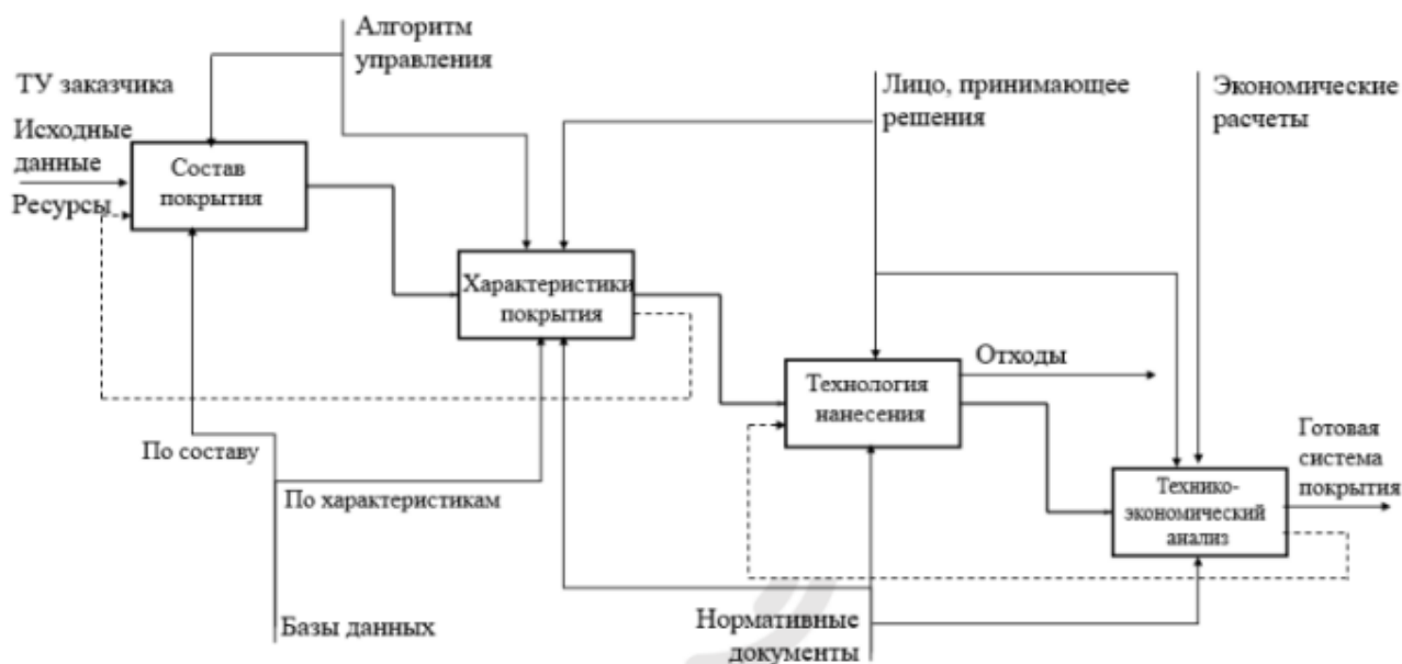
Рис. 1. IDEF0-диаграмма алгоритма выбора системы покрытия резервуаров для хранения нефти и нефтепродуктов
