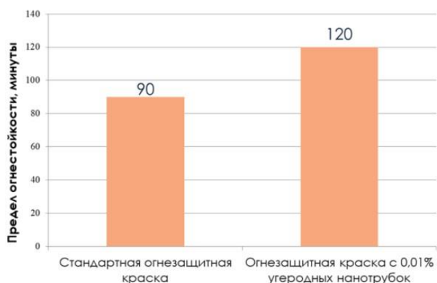
Рисунок 4. Сравнение предела огнестойкости двух образцов огнезащитных красок
