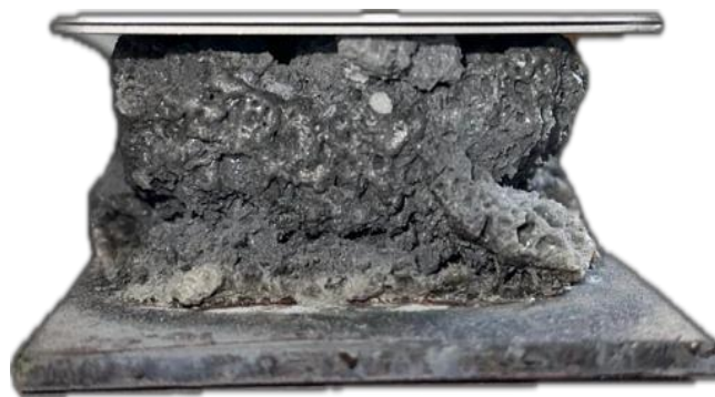
Рисунок 1. Пенококсовый слой с приложенной статической нагрузкой
