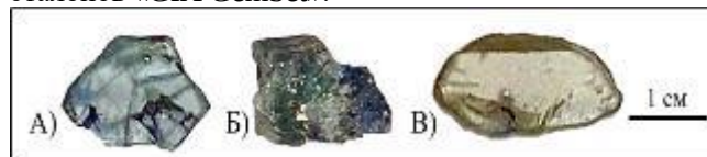
Рис. 3. (А, Б, В) Изменение цвета корундовых шлифов после протонного облучения
