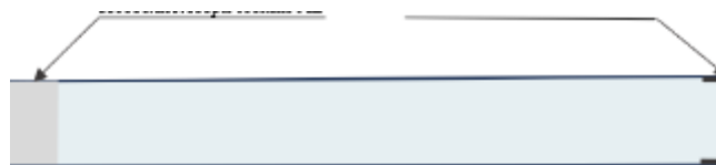
Рис. 2. Схема ампулы для метода «извлечения» избыточного компонента
