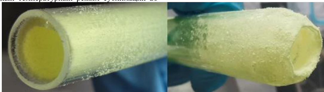
Рис. 1. Сублимированный препарат трис(8-оксихинолята) алюминия на оснастке из кварцевого стекла: до процесса извлечения из оснастки (слева) и после извлечения (справа)
