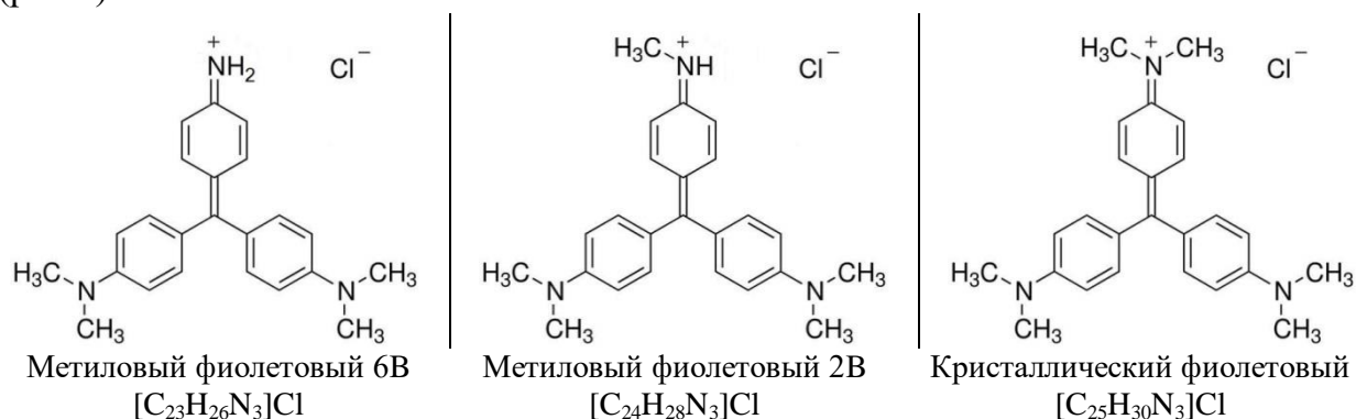
Рис.4. Структурные формулы трёх вариантов молекул метилового фиолетового
