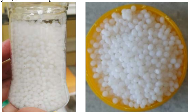
Рис. 4. Фотографические изображения гелей альгината после замены растворителя под давлением, проведенную через гомогенную область фазовой диаграммы тройной системы, и сверхкритической сушки
