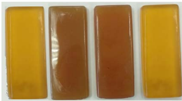
Рис. 2. Образцы материалов на основе полиэфирной смолы с концентрациями наночастиц MgO 1, 3, 5, 7 мас.%
