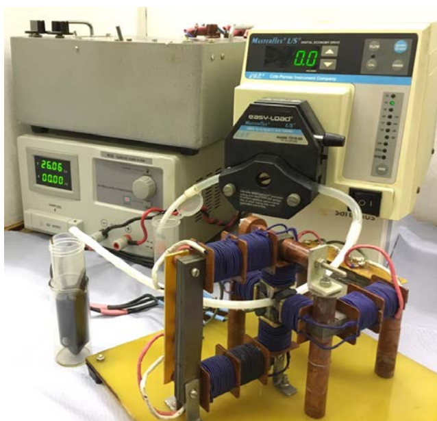
Рисунок 1. Фото проточной лабораторной установки для разрушения гель-содержащей водонефтяной эмульсии
