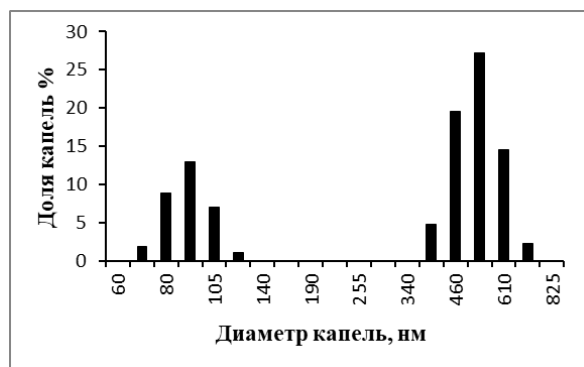
Рис. 1. Распределение капель по размерам в наноэмульсии, содержащей льняное масло. Концентрация Tween 60 и Span 60 - 2 об.%.
