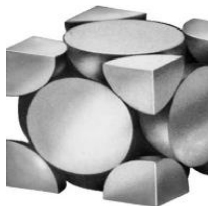
Рис. 1. Геометрическая структура элементарной ячейки ВПЯМ
