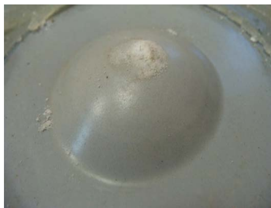
Рис. 3. Вздутие на поверхности порошкового эпоксидного покрытия, полученного при лабораторных испытаниях
