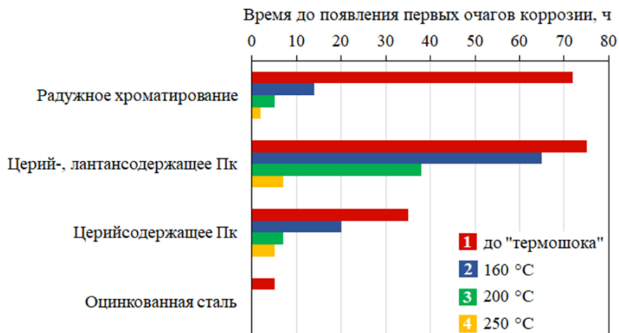
Рис. 1. Результаты коррозионных испытаний покрытий в камере соляного тумана
