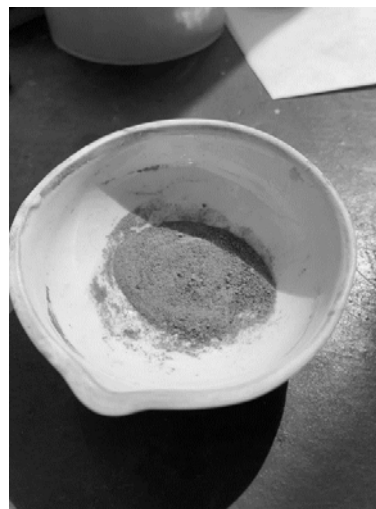
Рис.3. Мелкодисперсный катализатор - \text{MoO}_3(12\%)/\text{CoO}(4\%)/\text{Al}_2\text{O}_3
