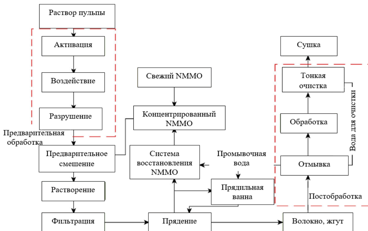
Рис. 1. Промышленный процесс производства лиоцеллового волокна в компании Swen Chemical Fiber Co. Ltd
