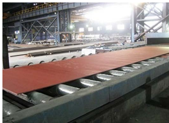
Рис. 1. Межоперационная грунтовка на автоматической поточной линии окраски
