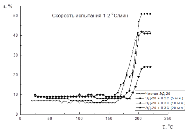
Рис. 2. Зависимость деформации образца от температуры испытания для чистой ЭД-20 и ЭД-20, модифицированной 5 м.ч., 10 м.ч. и 20 м.ч. ПЭС. Режим отверждения 180 °С, 8 ч
