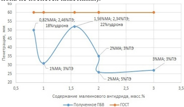
Рисунок 3 – Зависимость пенетрации от содержания малеинового ангидрида при 25°C
