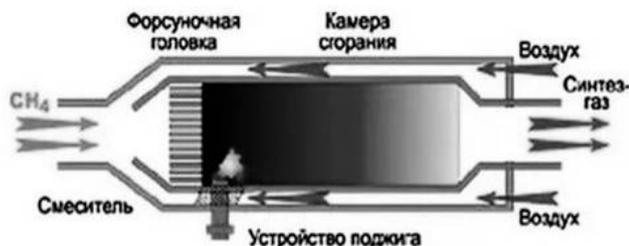
**Рисунок 2. Принципиальная схема генерации водородсодержащего синтез-газа с использованием систем искрового зажигания**
