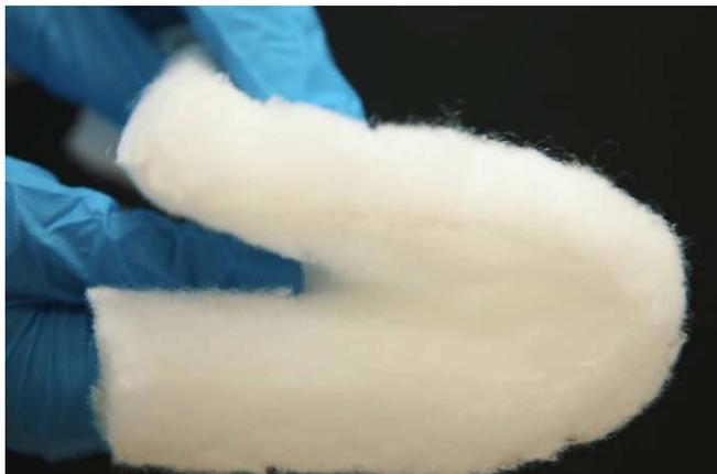
Рис. 1. Аэрогель на основе переработанных волокон ПЭТ
