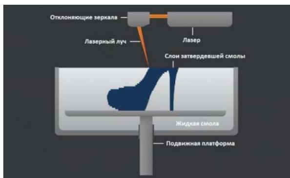
Рис. 2. Реализация технологии стереолитографии
