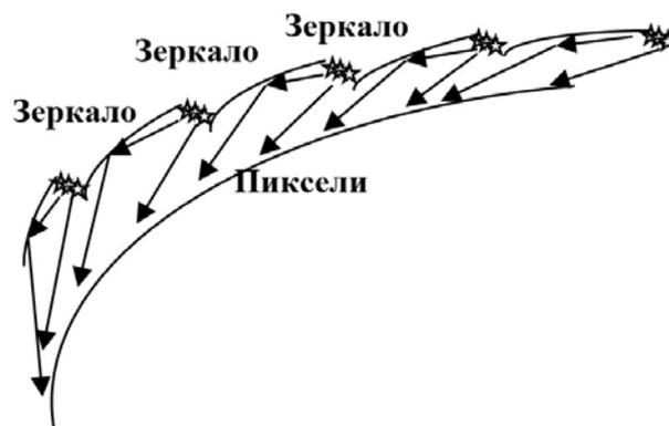
Рис.3. Гибкий экран. Свет распространяется в узком канале между зеркальной задней поверхностью и пикселями (точнее, цветоделительными призмами) (справа)
