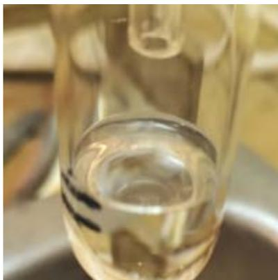
Рис. 3. Вид нижней части поглопителя Зайцева (с короткой трубкой) с о-ксилолом после его насыщения  $\text{BCl}_3$  в ходе опыта на рис. 2.
