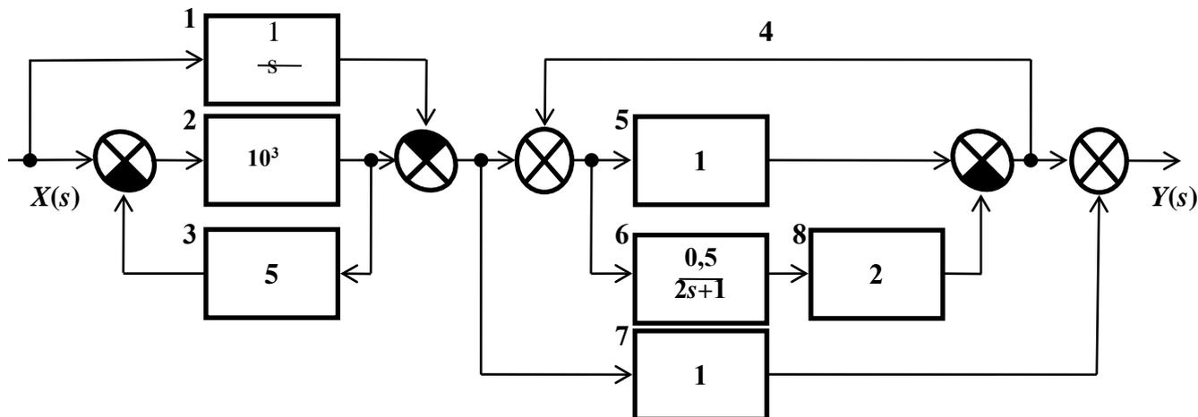
Назовите звенья. Получите передаточную функцию комбинации. Какому типовому динамическому звену эквивалентна комбинация? Постройте рамповую переходную характеристику полученного звена.
