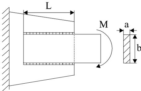
Определить требуемую длину  $L$  фланговых швов для приварки полосы к фасонному листу (косынке). Допускаемое напряжение на срез для швов  $[\tau]_{св} = 90$  МПа,  $M = 12$  кН м,  $a = 6$  мм,  $b = 150$  мм.
