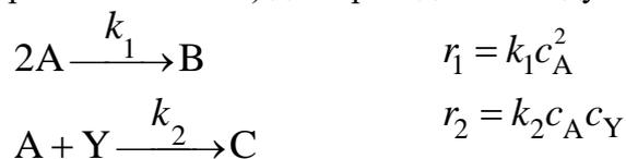
в периодическом реакторе таким образом, чтобы селективность образования продукта С была максимальной. Условия:  $\frac{k_2}{k_1} = 10$ ; диапазон изменений концентраций исходных
