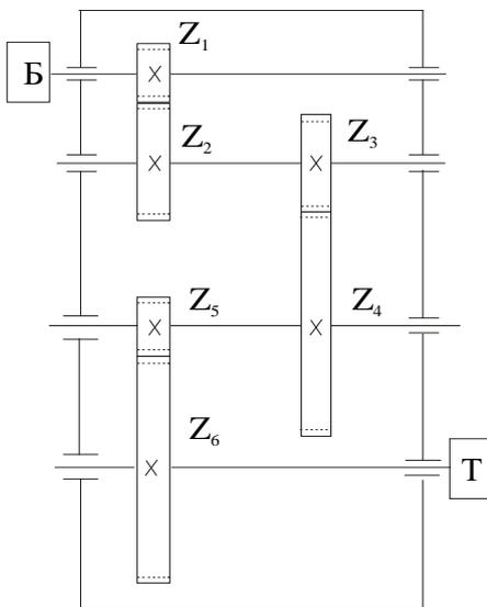
Входной вал трехступенчатого редуктора имеет частоту вращения  $n_{вх} = 2400 \text{ об/мин}$ , мощность на выходном валу  $N_{вых} = 3 \text{ кВт}$ ,  $z_1 = 20$ ,  $z_2 = 40$ ,  $z_3 = 24$ ,  $z_4 = 96$ ,  $z_5 = 20$ ,  $z_6 = 80$ . К.п.д. зубчатой пары  $\eta_{зуб.} = 0,95$ , к.п.д. одной пары подшипников  $\eta_{п.} = 0,99$ . Определить общее передаточное отношение редуктора  $i$ , число оборотов выходного вала  $n_{вых}$  и мощность на входе  $N_{вх}$ .
