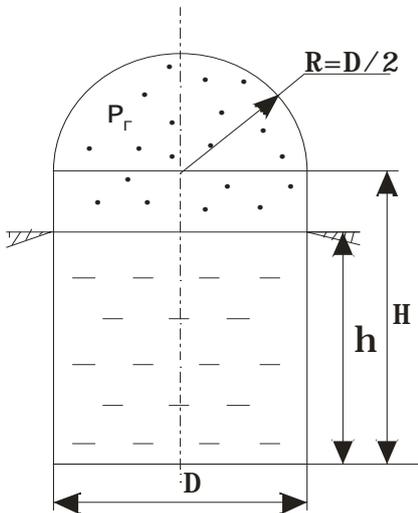
Цилиндрический сосуд, закрытый сверху сферической крышкой, заполнен жидкостью с плотностью  $\rho=1500 \text{ кг/м}^3$ , давление газа  $P_r=0,2 \text{ МПа}$ ,  $R = 1 \text{ м}$ ,  $D = 2 \text{ м}$ ,  $H = 8 \text{ м}$ ,  $h = 6 \text{ м}$ ,  $\sigma_T = 200 \text{ МПа}$ . Определить толщину стенки сосуда при запасе прочности  $n = 2$  и построить эпюры  $\sigma_m$  и  $\sigma_t$ .
