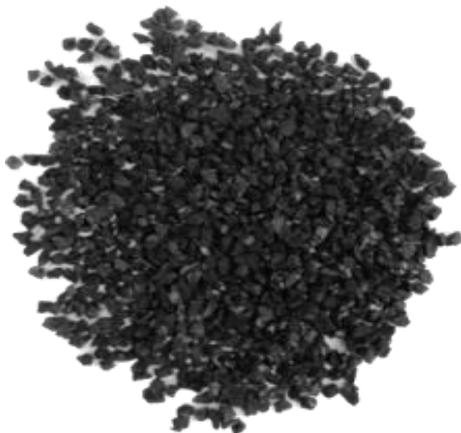
Рис. 1. Внешний вид углеродного композита на основе активированного угля марки ВСК
