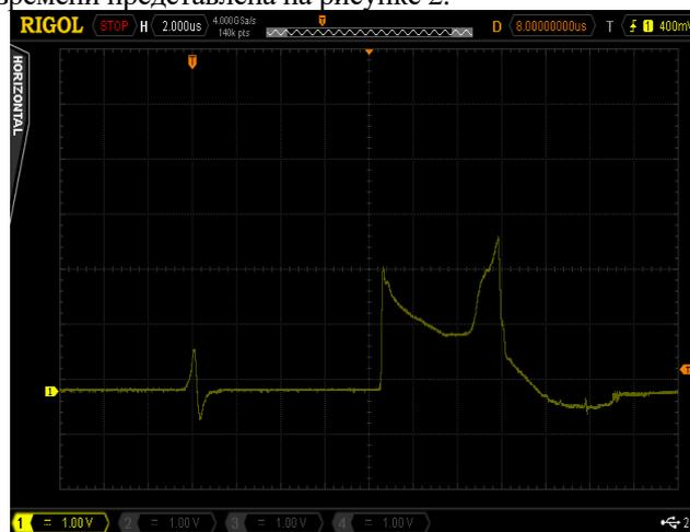
Рис. 2. Типовая осциллограмма записи ЭДС электромагнитным методом
