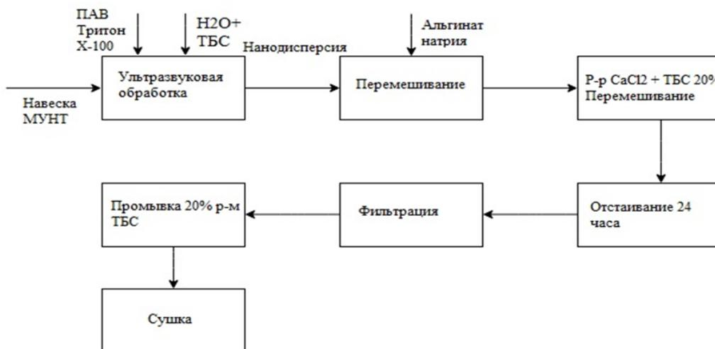
Рисунок 1. Схема получения аэрогелей на основе альгината кальция, модифицированных многослойными углеродными нанотрубками.
