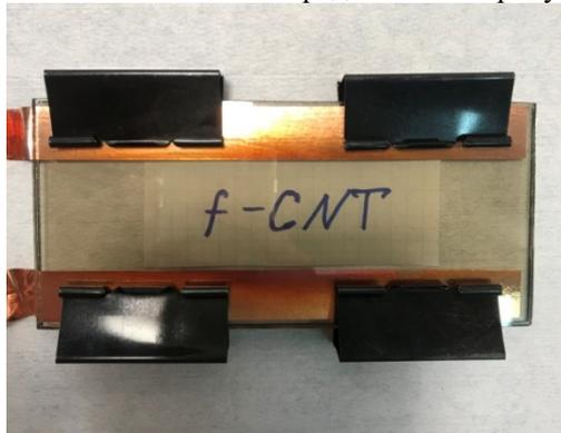
**Рис. 2 Фотография готовой сборки нагревательного элемента на основе углеродных нанотрубок.**
