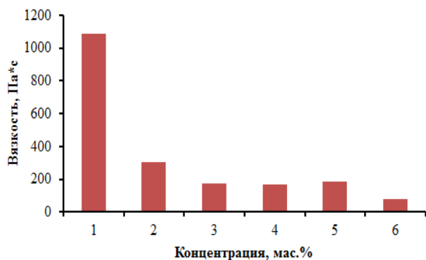
Рис.1. Вязкость жидких кристаллов в зависимости от концентрации масла чайного дерева при скорости сдвига 10 \text{ c}^{-1}
