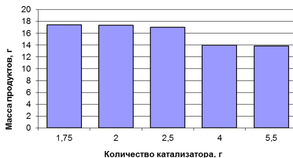
Рис. 3. Зависимость массы выходящих продуктов от конверсии солей
