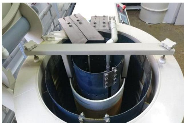
Рис.2. Электролизер с пористой керамической диафрагмой для окисления церия ООО «ЛИТ»
