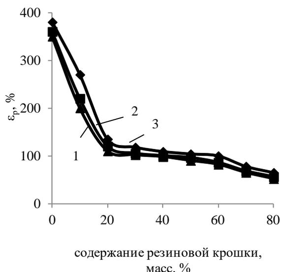
Рис. 2. Зависимость относительного удлинения при разрыве наполненных вторичных полиолефинов от количества резиновой крошки: 1 – один пропуск через экструдер; 2 – два пропуска через экструдер; 3 – три пропуска через экструдер
