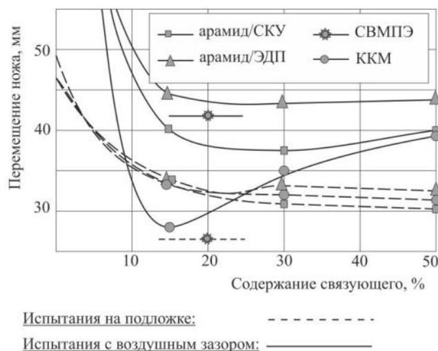
Рис. 1. Противопорезная стойкость тонких композитных пластин с поверхностной плотностью 1,3 кг/м<sup>2</sup>
