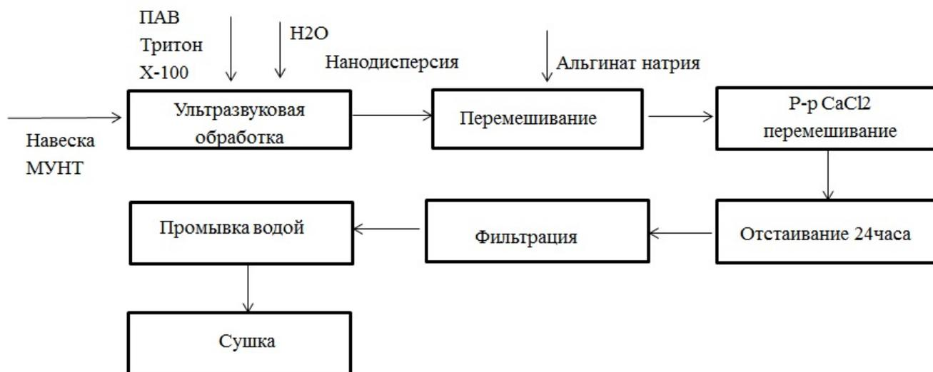
Рисунок 1. Методика получения аэрогелей на основе альгината кальция, модифицированных многослойными углеродными нанотрубками
