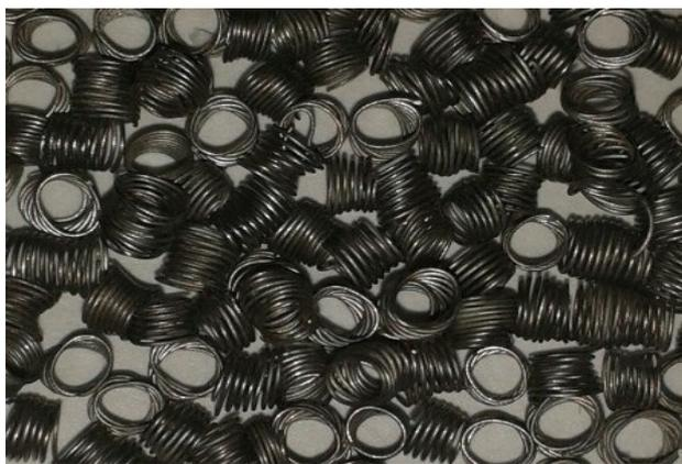
Рис.1. Поверхность ячеисто-каркасной металлической структуры.
