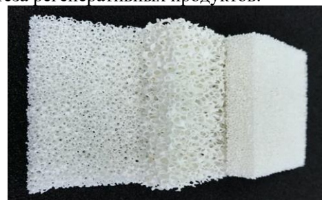
Рис. 3 Внешний вид образцов ВПЯН
