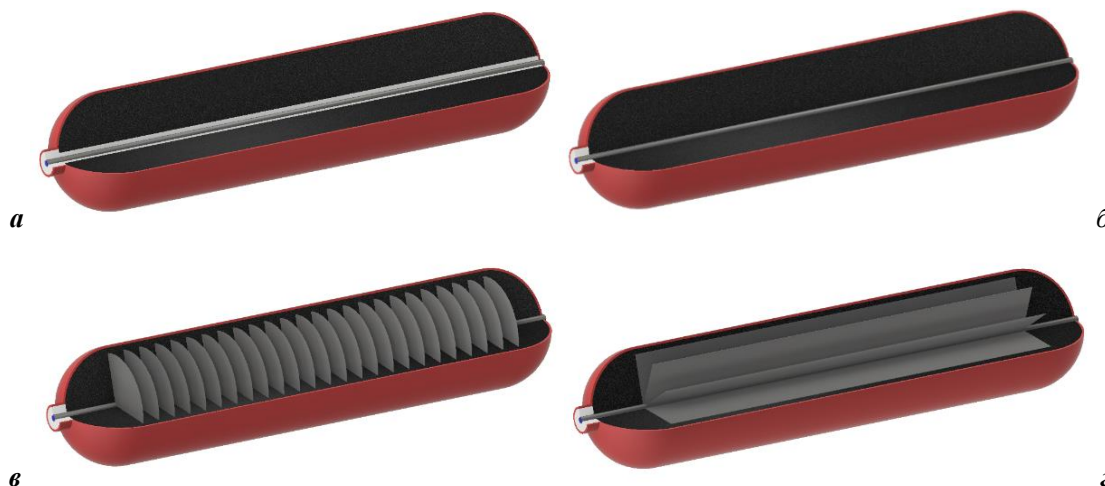
Рисунок 1. Виды конструкций аккумулятора АПГ с разными системами терморегулирования в виде трубного внутреннего теплообменного аппарата без оребрения с газовым каналом (а), без газового канала (б), с поперечными (в) и продольными ребрами (г).
