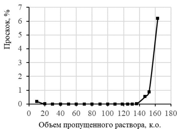
Рис. 2 Сорбционные кривые извлечения 137 Cs из щелочных ВАО на сорбенте Ферсал
