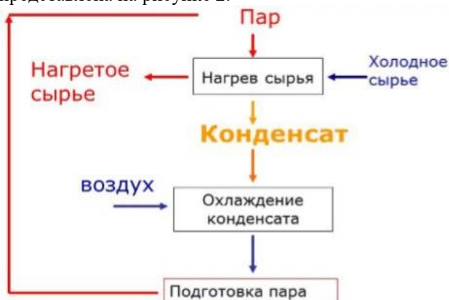
Рис.2. Блок-схема рецикла теплоносителя.
