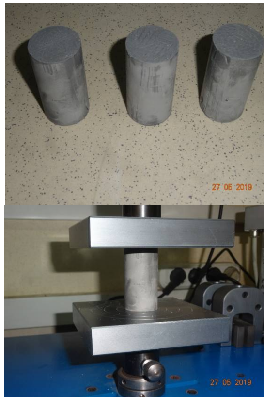
Рисунок 2. Общий вид образцов для испытания на сжатие.
