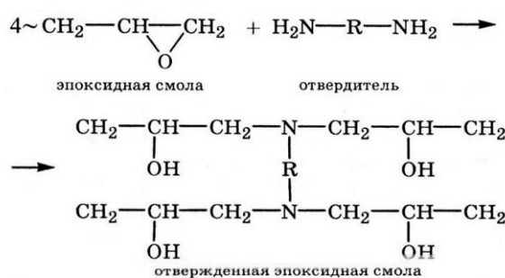
Рисунок 1 Схема протекания реакции отверждения эпоксидной смолы полиаминным отвердителем.
