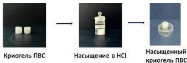
Рис. 1. Схема получения криогелей ПВС, насыщенных в концентрированной соляной кислоте.
