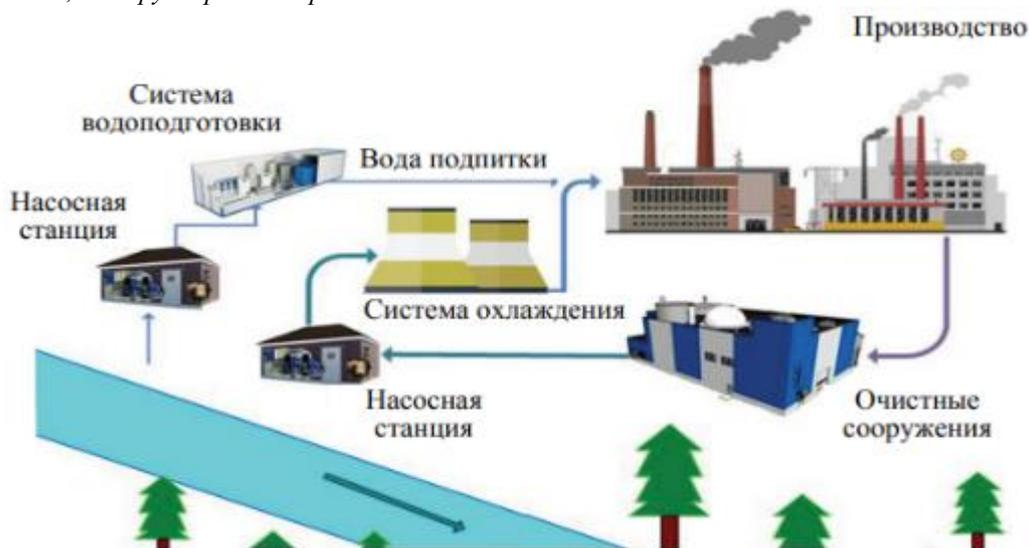
Рисунок 3. Схема оборотного водоснабжения [4]
