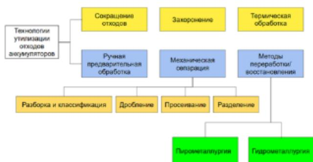
Рисунок 2. Существующие решения по утилизации отходов аккумуляторов [1].
