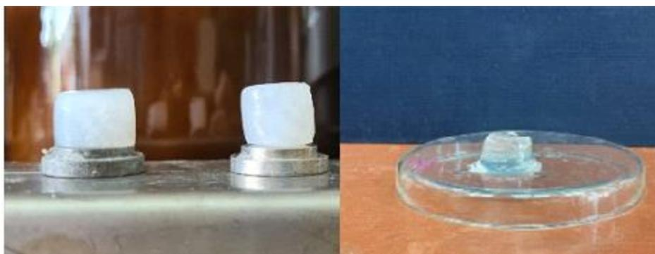
Рис.4. Фотографии криогелей ПВС. Слева – сформированный КГПВС без добавок; справа – этот же КГПВС, насыщенный в растворе ГГХ до установления равновесной концентрации 4 моль/л.
