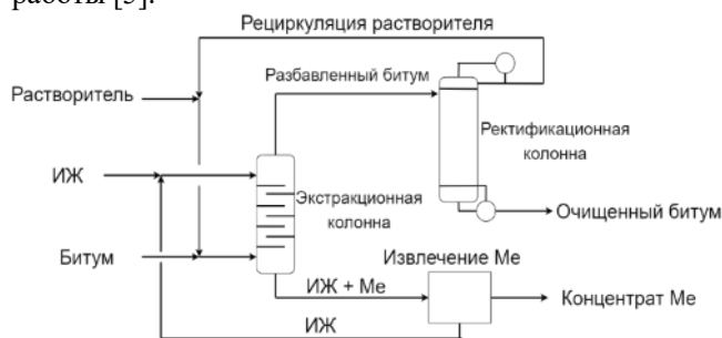
Рис. 1 Технологическая схема ионно-жидкостной экстракции разбавленного растворителем битума
