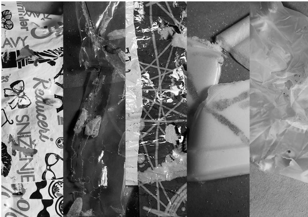
**Рис 1. Характерные отверстия на следующих пластиках: полиэтилен высокого давления, полиэтилен низкого давления, полипропилен, полистирол и поливинилхлорид соответственно.**
