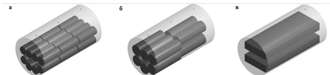
Рис. 4. Расположение гелей различной формы в аппарате высокого давления: а – эксперимент VI, цилиндры, характеристический размер R = 5.75 мм, 24 шт.; б – эксперимент VII, цилиндры, характеристический размер R = 7.46 мм, 10 шт.; в – эксперимент VIII, пластины, характеристический размер h/2 = 5.75 мм, 2 шт.
