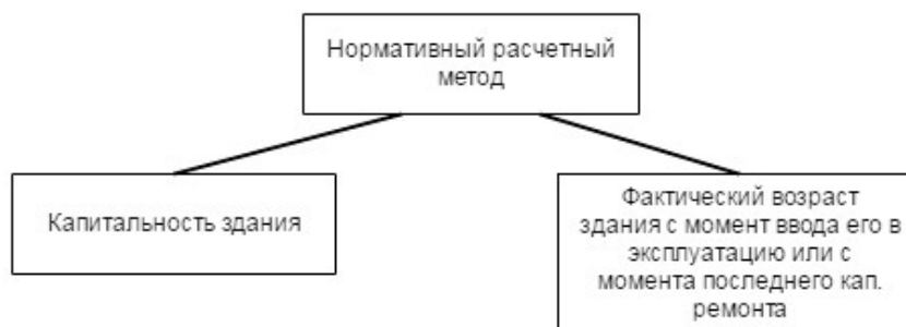
Рис. 3. Принципиальная блок-схема нормативного расчетного метода
