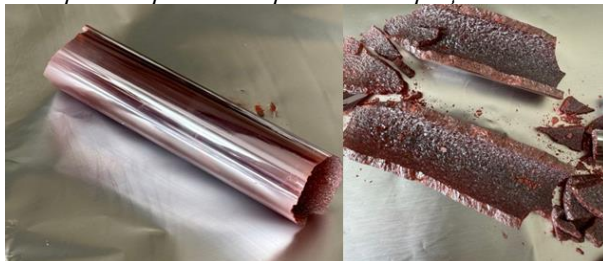
Рис. 3. Внешний вид поликристаллического сублимата теллурида цинка извлеченного из приемника.
