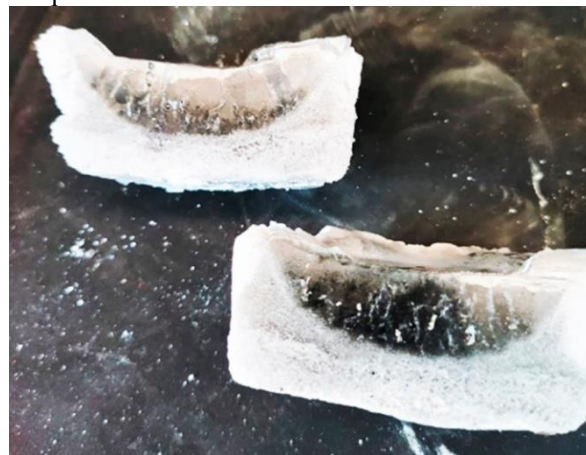
Рис. 3. Поликристалл после пилки, шлифовки и полировки.
