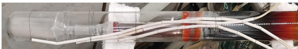
Рис. 2. Внешний вид реактора после проведения процесса очистки теллурида цинка.
