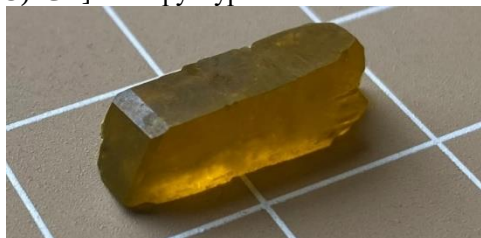
Рис 2. Полученный монокристалл \text{Rb}_2\text{NiCl}_4 \cdot 2\text{H}_2\text{O} .
