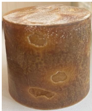
Рис. 5. Изделие из ЭНМ, изготовленное методом кусковой заливки, с использованием гранул
