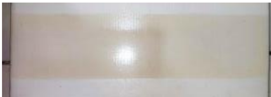
Рис. 2. Пленка на фторопластовой подложке
